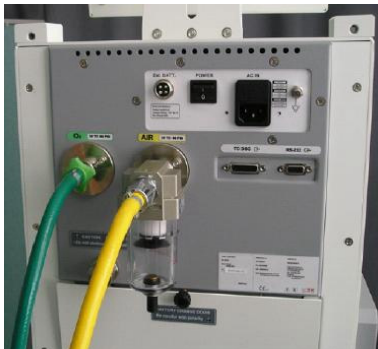
Fig. 4. Water trap이 연결된 공기 연결부.
